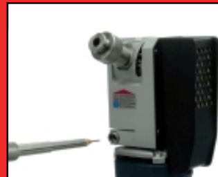
Präzise Bestimmung der Abschleiflänge an der Wolframelektrode.
