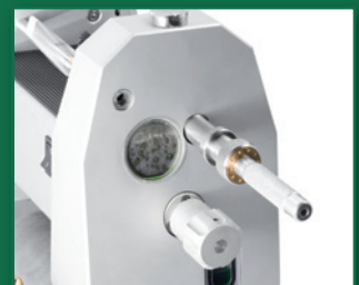
Das Hebel drehen um die Elektrode zu schneiden
