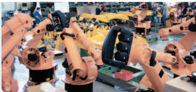
Roboterschweißzellen vor der Auslieferung
