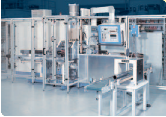
Sondermaschine zum Buckelschweißen von Anschluss-Stutzen auf Hydraulikzylinder für Lenkgetriebe
